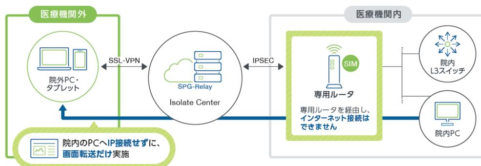
医療機関に専用ルータを設置して頂くだけの手軽さで、院外の閲覧PCと、院内の電子カルテPCとの間で画面転送を行い、遠隔地で安全に電子カルテを閲覧・操作できる仕組みです。
